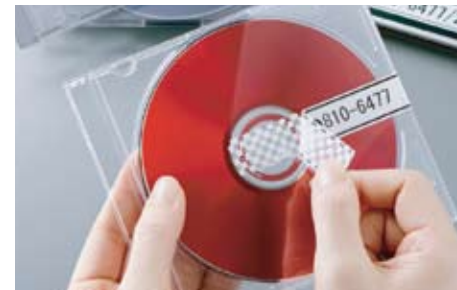
Sikkerhetstape: En spesiell tape som etterlater et rutemønster dersom fjernet, og som ikke fester på nytt når fjernet.
