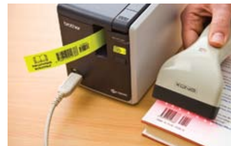
Skriv ut skreddersydde etiketter som inkluderer en kopi av en skannet strekkode uten behov for en PC*
