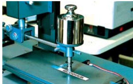
Slitasjebestandig: En sliteenhet på 1 kg ble ført over de laminerte etikettene 50 ganger. Teksten ble ikke berørt av dette.
