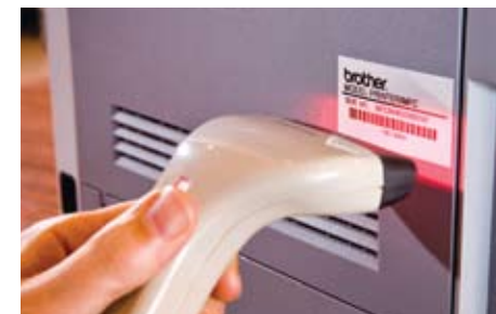
Skann den ønskede strekkoden for å sende data til P-touch 9800PCN
