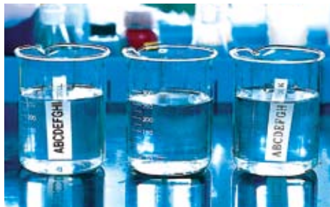
Vann- og kjemikaliebestandig: Glassplater med laminerte etiketter på ble senket i vann og diverse kjemikalier i to timer. Teksten ble ikke berørt av dette.
